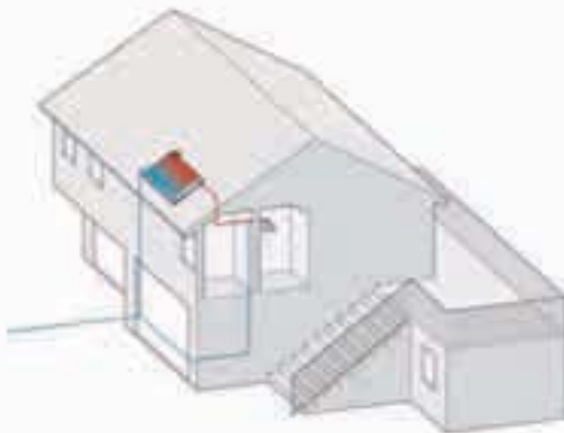
① Stand Alone con montaje sobre tejado
